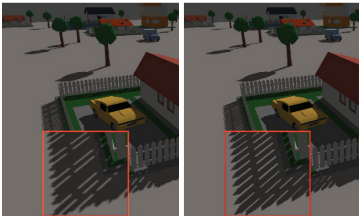
图 7.19：左图：场景的可见区域很大，导致单张阴影贴图使用了 2048 \times 2048 的分辨率，从而避免透视走样（锯齿）。右图：在观察方向上使用了四个 1024 \times 1024 的阴影贴图，大大提高了阴影的质量[1963]。上图红框中展示了围栏前角的放大结果，可以看到右侧的阴影质量更高。
