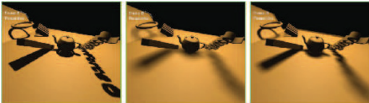
图 7.25: PCF 和 PCSS。左图中，使用了一点点 PCF 滤波后的硬阴影。中间的图展示了由 PCF 生成的、具有恒定柔和宽度的软阴影。右图中，在物体与地面相接触的地方，PCSS 具有适当硬度的、可变宽度的软阴影效果。
