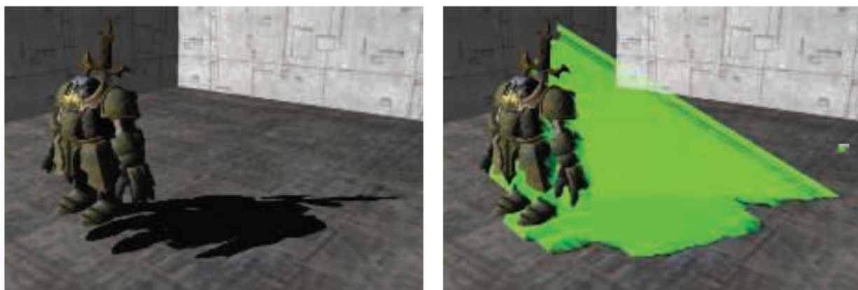
图 7.9：阴影体算法。左图中的角色投射了一个影子，右边展示了这个模型所产生的阴影体三角形。[1280]
