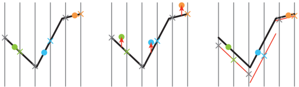
图 7.13：阴影偏移。表面正上方有一个光源，这个表面会被渲染到一个阴影贴图中，图中的灰色竖线代表了阴影贴图的像素中心，阴影贴图会在 \times 位置处记录遮挡深度。我们想要知道，表面上的这三点是否会被光源照亮，最近的阴影贴图深度值会使用相同颜色的 \times 进行表示。左图中，如果没有添加偏移，那么蓝色和橙色样本将会被错误地认为处于阴影中，因为与对应的阴影贴图深度相比，它们距离光源更远。在中间，从每个样本中都减去了恒定的深度偏移，使得每个样本都更加靠近光源，但是此时蓝色样本仍然会被认为处于阴影中，因为它距离光源还是要更远一点。右图中，在构建阴影贴图的时候，会根据每个多边形的斜率，对其偏移量进行修正，然后再让其按照偏移量稍稍靠近光源（样本），这样所有的样本深度都要比阴影贴图深度更加靠近光源，因此它们都会被光源照亮。
