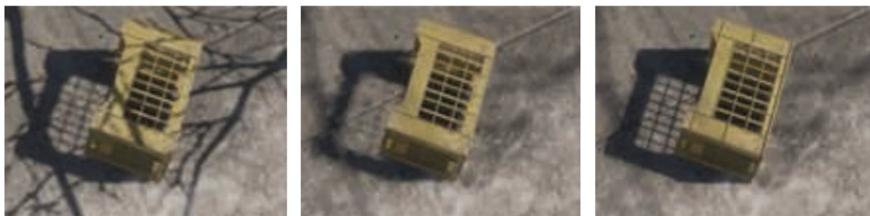
图 7.31：左图：PCF 会为所有物体都生成均匀的软阴影。中间：PCSS 会根据与遮挡物的距离，来对阴影进行软化，但是与板条箱左下角重叠的树枝阴影，会产生一些瑕疵。右图：来自 IZB 的尖锐阴影与来自 PCSS 的柔和阴影进行混合，给出了一个改进的结果。[1711]
