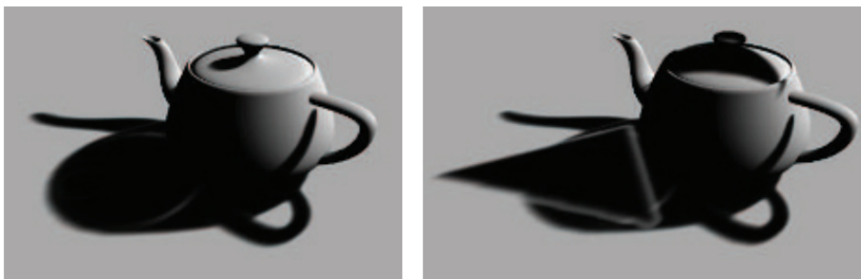
图 7.28：左图：使用了 VSM 来生成茶壶的阴影。右图：一个位于上方的三角形（未显示在图中）在茶壶上投射下阴影，产生了令人反感的阴影瑕疵。
